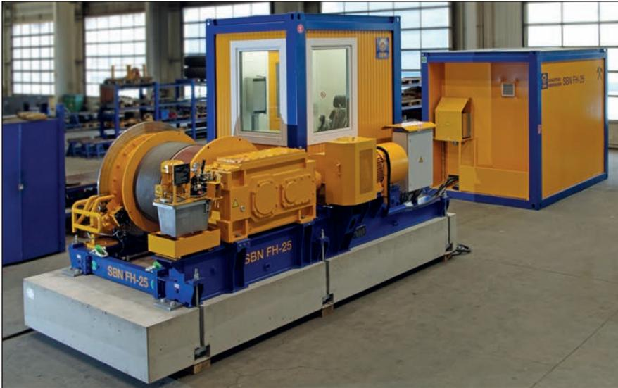
Der Förderhaspel SBN FH-25 der SCHACHTBAU NORDHAUSEN GmbH ist als Antriebsmaschine von Schacht- und Schrägförderanlagen im Bergbau konzipiert und kann sowohl zur Führung von Personen als auch zum Transport von Material zur Versorgung untertägiger Grubenräume und Schächte eingesetzt werden.
