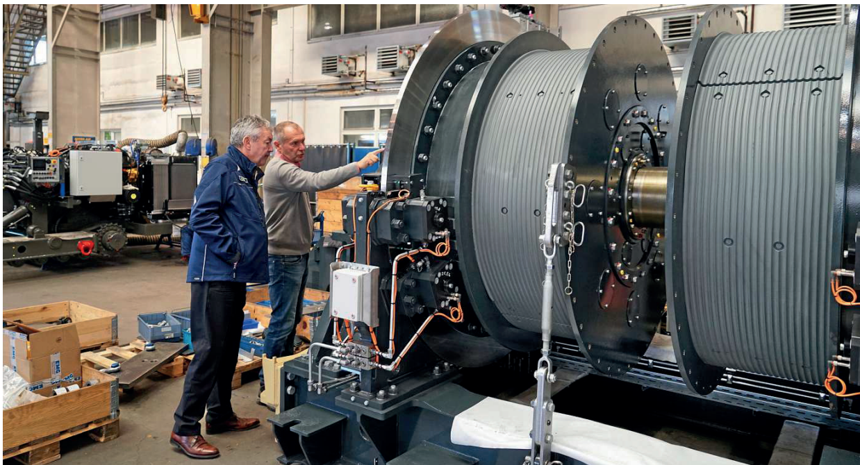
Diese große Förderhaspel entwickelten und bauten die Schachtbauer für das Lehr- und Forschungsbergwerk der TU Bergakademie Freiberg. Geschäftsführer Michael Seifert (links) lässt sich von Knut Große Details erklären.
