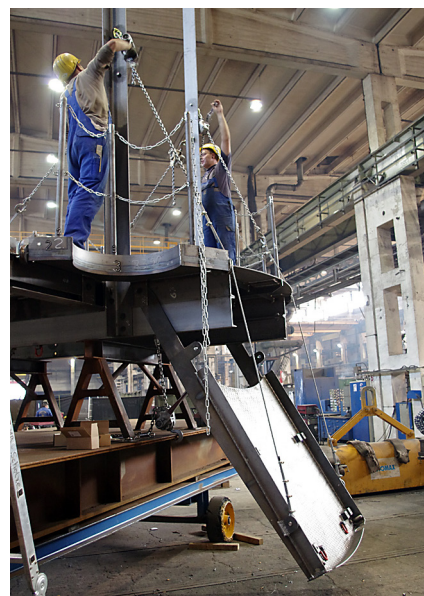
Foto links: Ober- und Unterbühne mit Ausklappelementen, Belastungstest des Netzverzuges (da es im Regelwerk keine dynamischen Lastannahmen für im Schacht abstürzende Massen gibt wurde ersatzweise ein statischer Versuch mit einer Belastung von 400 kg auf ein Segment durchgeführt Zeichnung links: Spannseilumlenkung Zeichnung rechts: Gesamtdarstellung der zweietagigen Arbeitsbühne mit Ausklappelementen Foto rechts: Funktionstest der Ausklappelemente vor Auslieferung der Bühne an die Baustelle
