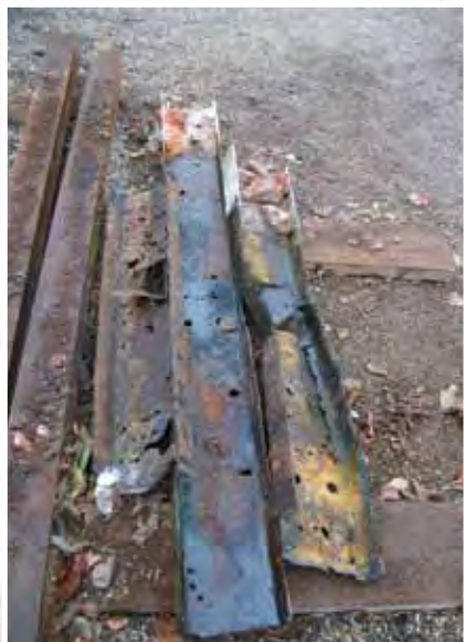
Geraubte, korrosionsgeschädigte Einstriche
