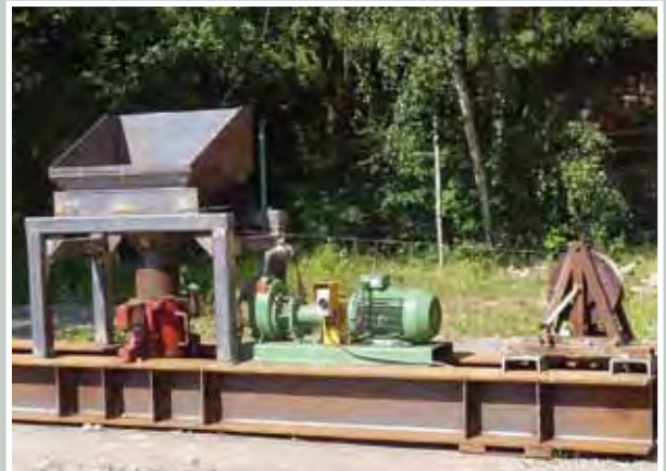
Verfüll-, Meß-, Abpumpeinrichtung
