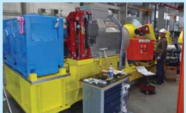
Bau und Montage einer Hubwinde
