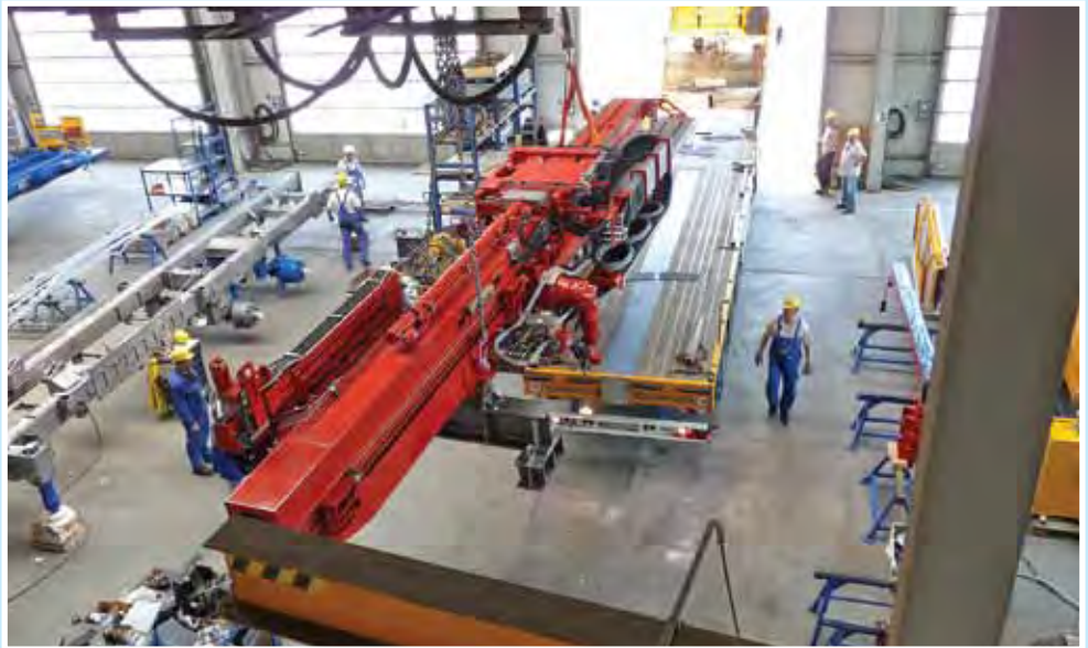
Verladung der Gestängehandhabung aus der Montage für den Transport nach Edelshausen
