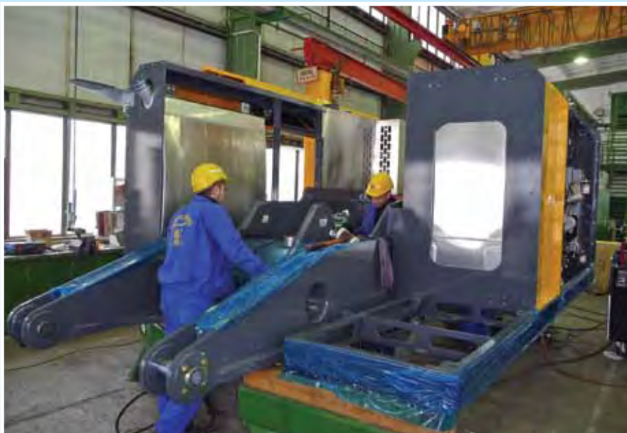
Manuel Goldhorn und Sebastian Müller bei der Montage des Oberwagens BT 55 H
