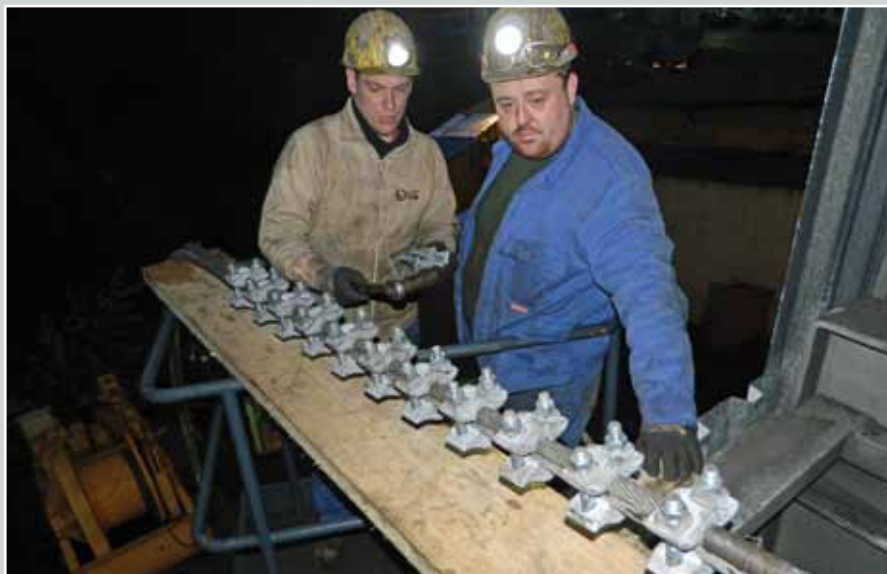
Herstellen eines neuen Seileinbandes durch Mathias Scholze (rechts) und Christian Müller
