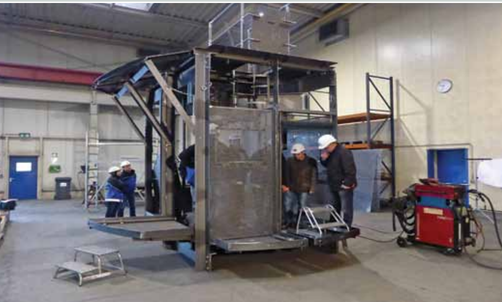
Fördergestell mit integrierten Klappsegmenten – Vormontage in NDH
