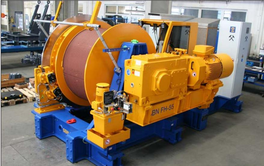
Der Förderhaspel SBN FH-55 der SCHACHTBAU NORDHAUSEN GmbH ist als Antriebsmaschine von Schacht- und Schrägförderanlagen im Bergbau konzipiert und kann sowohl zur Fahrung von Personen als auch zum Transport von Material zur Versorgung untertägiger Grubenräume und Schächte eingesetzt werden.
