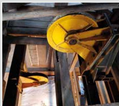
*Auf dem Schachtgerüst montierte Umlenken-
