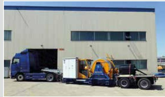
Der SBN FH-55 kann mittels Modulfahrwerk transportiert werden.
