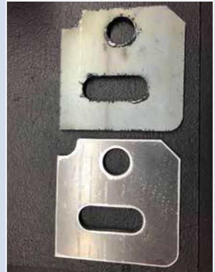
Zwei Bleche vorher und nachher: Schlacke und Oxidschicht wurden entfernt, die Kanten abgerundet.
